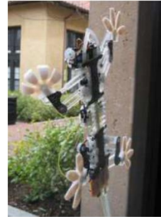
StickyBot, robot-gecko (S. Kim, Stanford, 2005)
